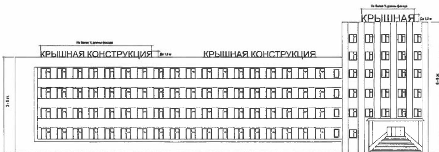
10-15 этаж. Не более 1/2 длины фасада. Высота конструкции до 2 м.
